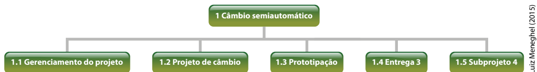
Figura 18 - Fases do ciclo de vida do projeto no segundo nível da EAP Fonte: do Autor (2015)
