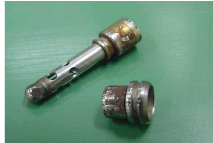
Componentes internos do bico com corrosão
