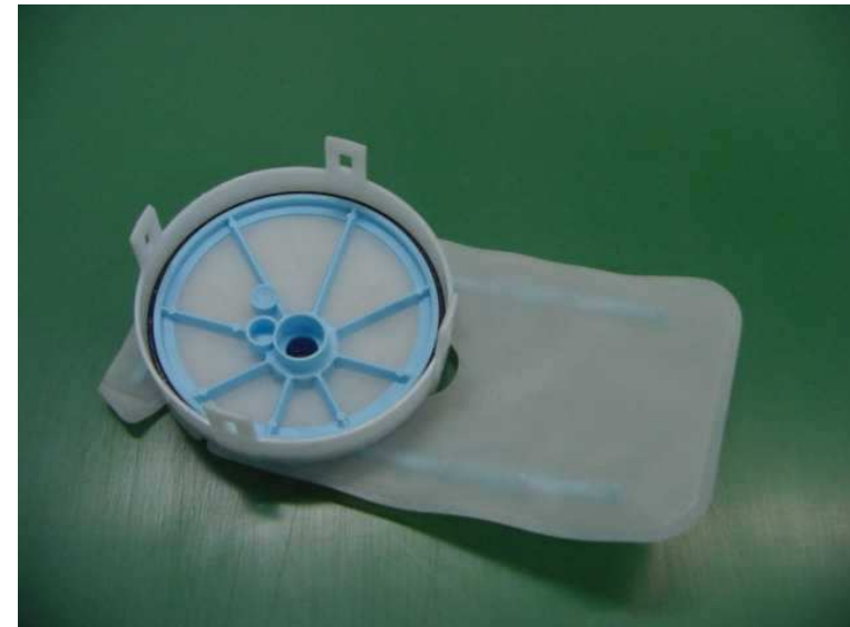
Filtro sem depósitos
