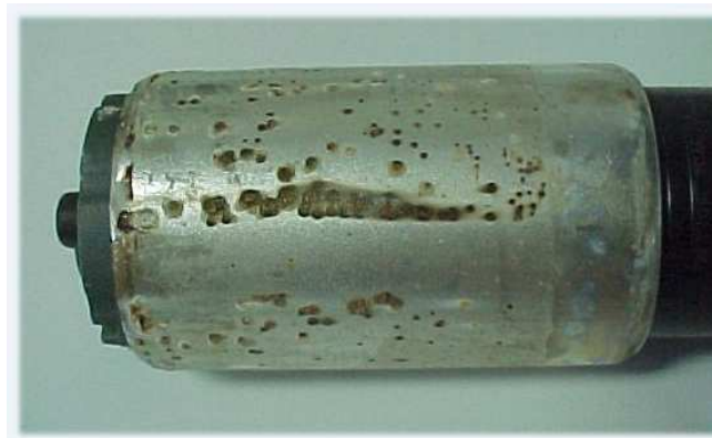
Corrosão tipo "pitting" na carcaça
