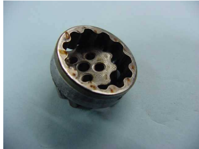
Corrosão nos roletes
