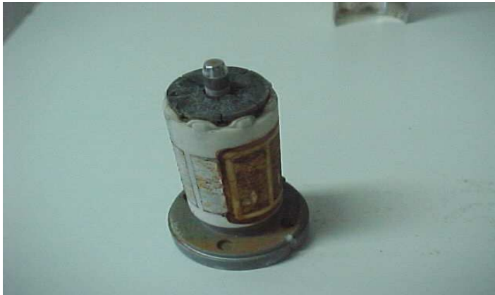
Corrosão nos eletro-ímãs do induzido
