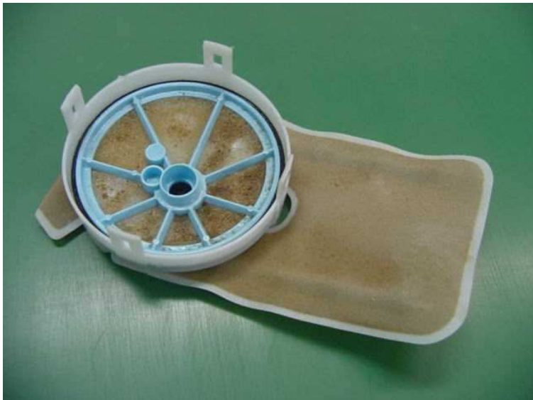
Filtro obstruído com depósitos
