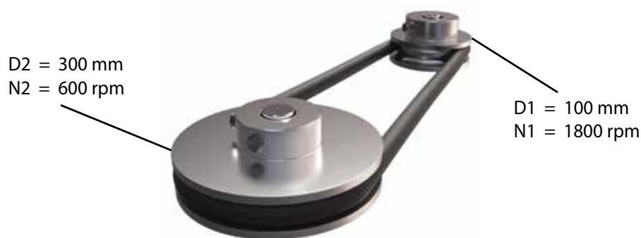
Figura 188 - Sistema de transmissão por correia
