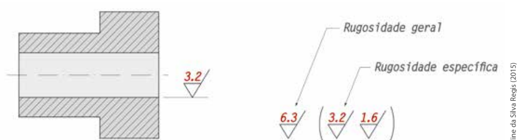
Figura 287 - Símbolos de representação à rugosidade média Ra Fonte: do Autor
