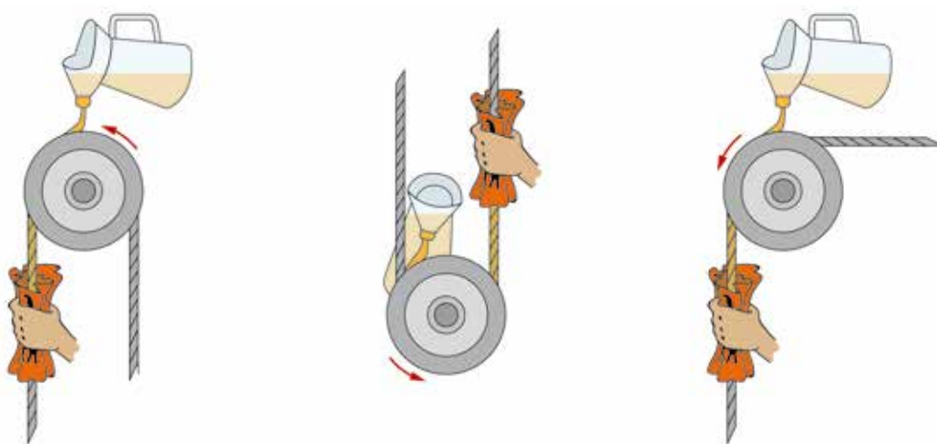
Figura 384 - Método de lubrificação manual Fonte: do Autor
