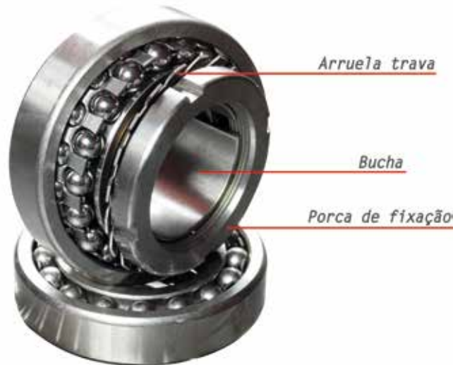
Figura 421 - Conjunto rolamento auto compensador, bucha, porca de fixação e arruela trava
