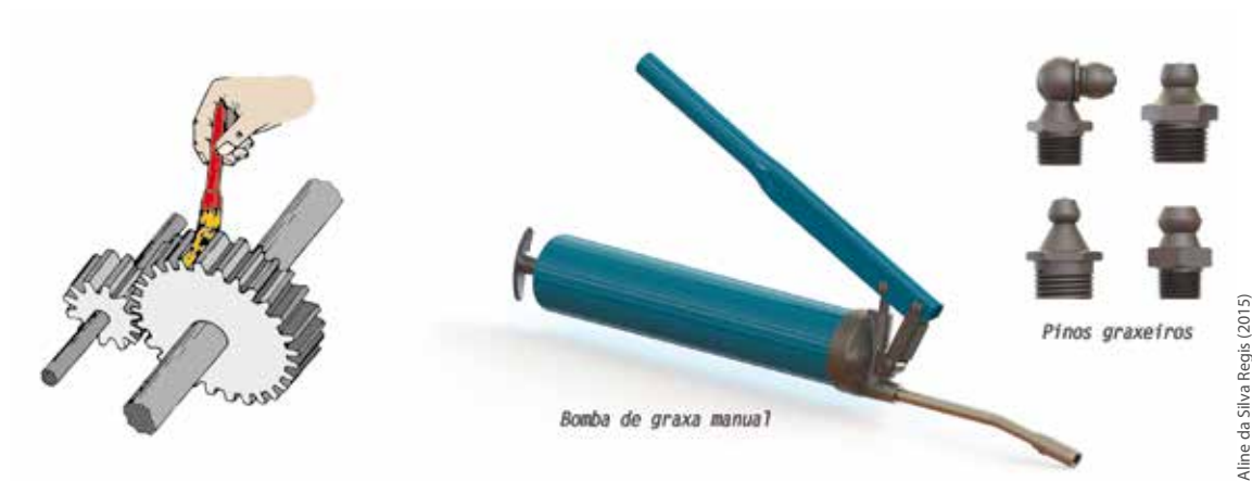
Figura 426 - Lubrificação com pincel e com bomba através de pino graxeiro Fonte: do Autor
