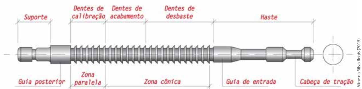
Figura 355 - Brocha interna de tração Fonte: Adaptado de (SECCO et al., 2009a)
