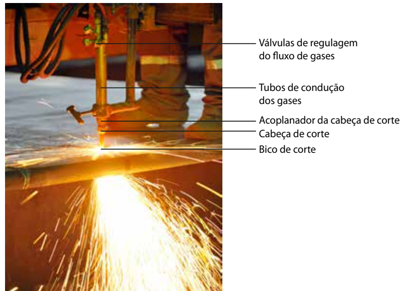
Figura 312 - Partes do maçarico de corte
