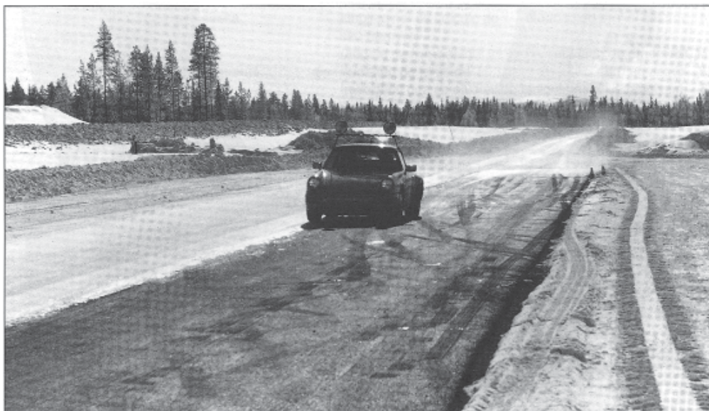
Teste de inverno do ABS/ASR no norte da Suécia com coeficientes de atrito diferentes entre as rodas direitas e esquerdas ( \mu -split).
