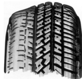
Exemplo de pneu com desgaste irregular devido ao câmbio incorreto.
