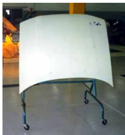
Suporte que auxilia o apoio e a movimentação de peças para a realização das diversas etapas do processo de repintura
