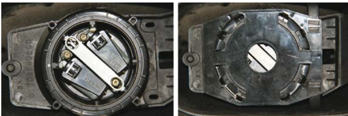
Figura 31 - Placa fixação espelho retrovisor e motores de movimento Fonte: Banco de imagens SENAI/SC – São José/Palhoça
