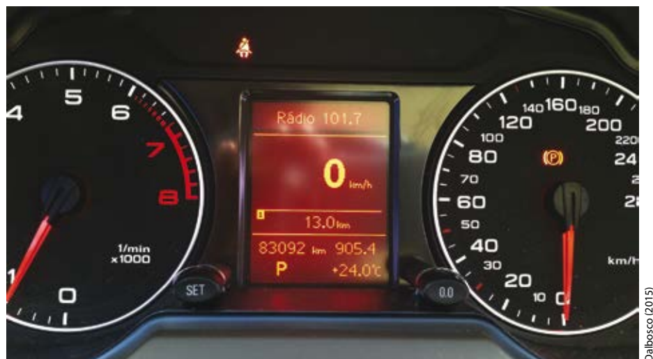
Figura 77 - Hodômetro parcial Fonte: dos Autores (2015)
