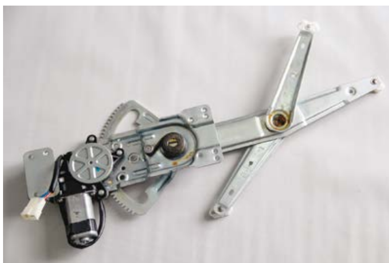
Figura 10 - Mecanismo pantográfico movido a engrenagem Fonte: Banco de imagens SENAI/SC – São José/Palhoça
