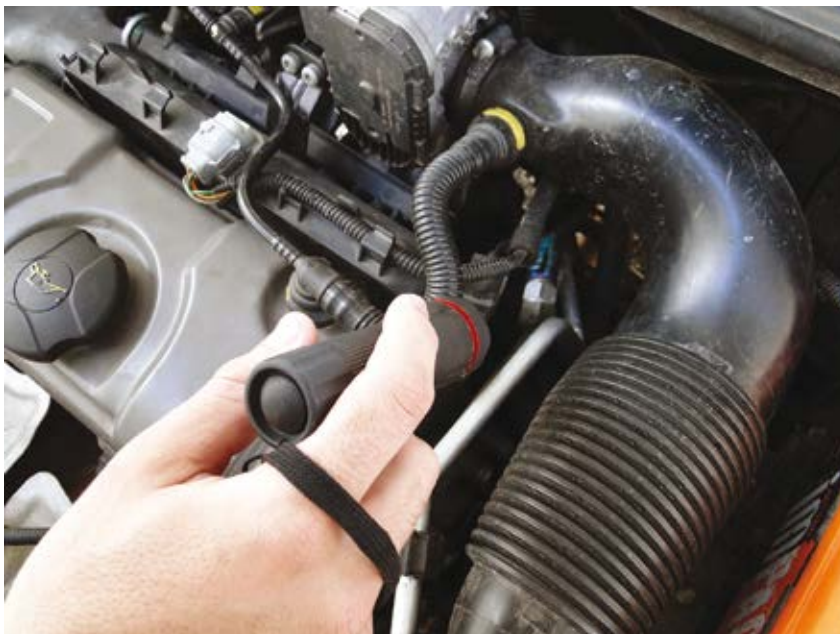
Figura 59 - Lâmpada raios ultravioleta para detecção de vazamentos Fonte: Banco de imagens SENAI/SC – São José/Palhoça
