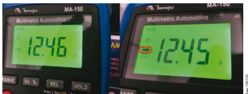
Figura 26 - Alimentação do motor acionador da trava elétrica, alternando entre trava e destrava Fonte: dos Autores (2015)
