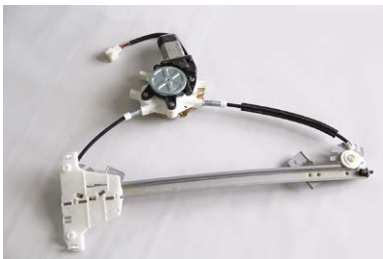
Figura 11 - Mecanismo movido a cabo de aço Fonte: Banco de imagens SENAI/SC – São José/Palhoça
