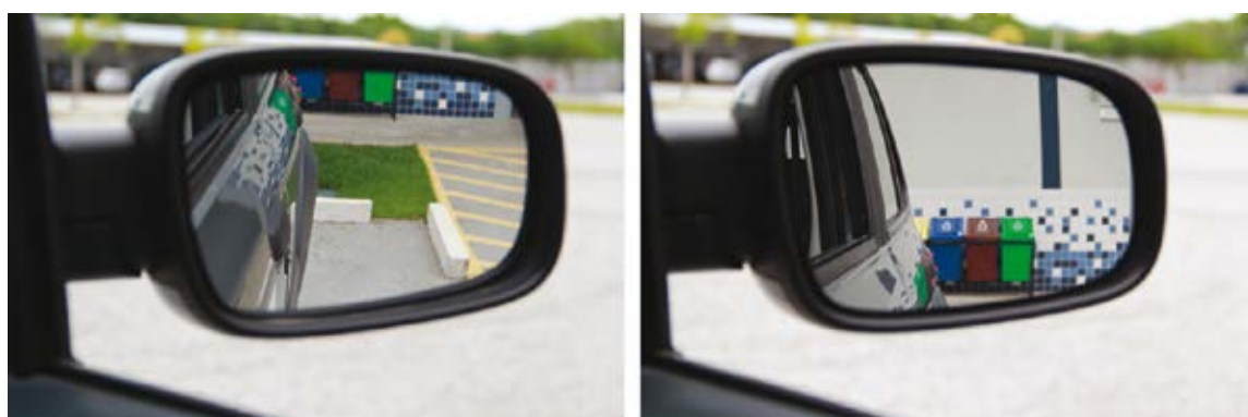
Figura 33 - Funcionamento do sistema tilt-down Fonte: Banco de imagens SENAI/SC – São José/Palhoça
