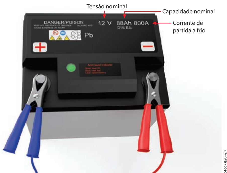
Figura 23 - Especificação técnica da bateria automotiva Fonte: Thinkstock (2015)
