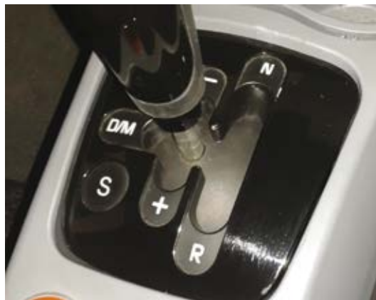
Figura 85 - Comando do câmbio automatizado do tipo alavanca Fonte: Banco de imagens SENAI/SC – São José/Palhoça (2015)
