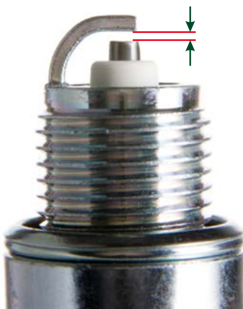
Figura 24 - Vela com folga Fonte: adaptado de Thinkstock (2016)
