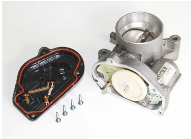
Figura 52 - Dispositivo do sensor de posição da borboleta Fonte: Banco de imagens SENAI/SC – São José/Palhoça (2015)
