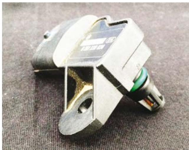
Figura 32 - Sensor conjugado temperatura do ar e MAP Fonte: Banco de imagens SENAI/SC – São José/Palhoça (2015)
