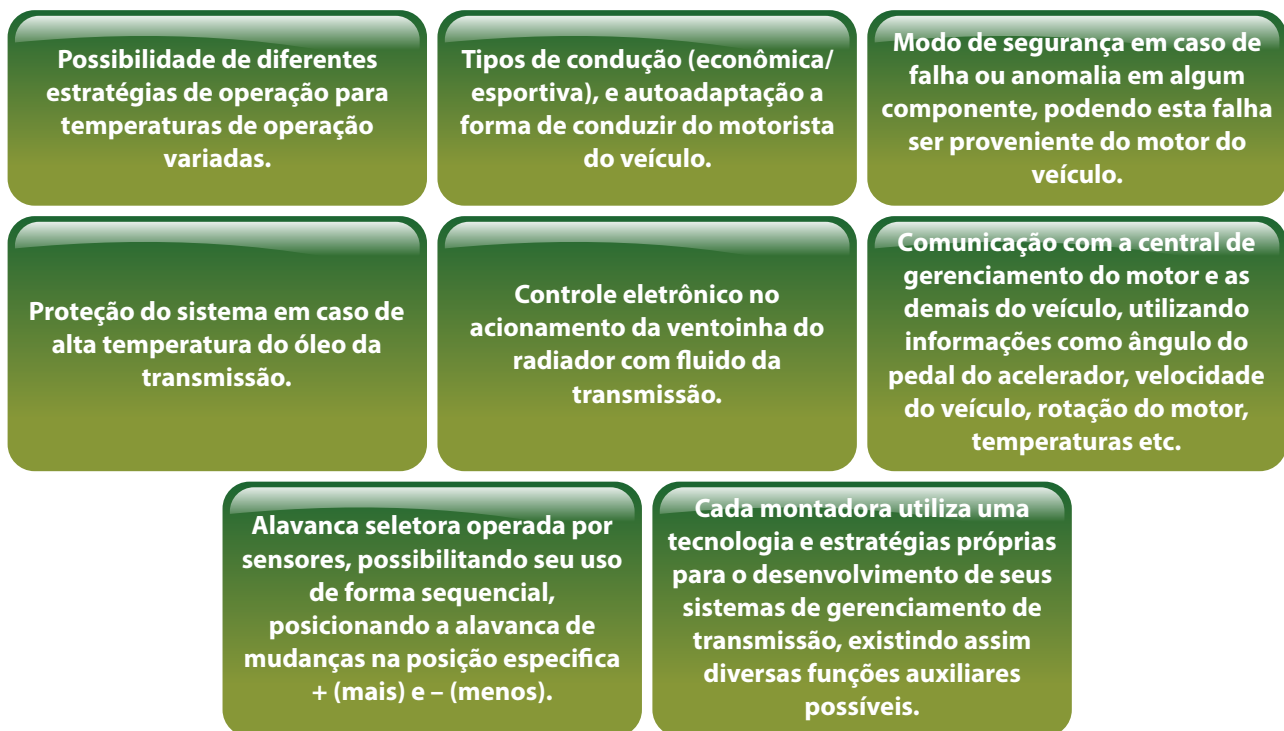
Figura 88 - Funções da central de gerenciamento eletrônico Fonte: do Autor (2016)
