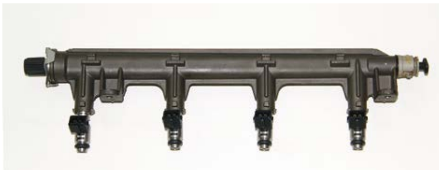
Figura 40 - Tubo distribuidor de alumínio anodizado Fonte: Banco de imagens SENAI/SC – São José/Palhoça (2015)
