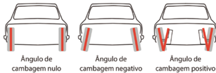
Figura 54 - Cambagem ou câmbio Fonte: Adaptado de Costa ([20--?])
