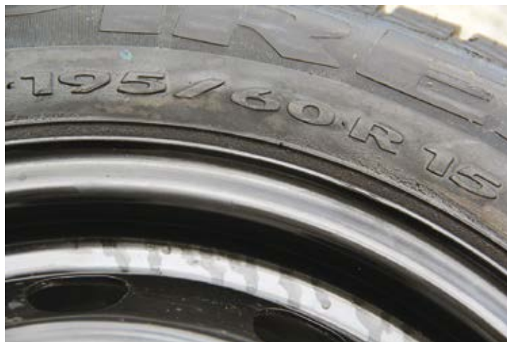
Figura 32 - Detalhe medidas do pneu Fonte: Banco de imagens SENAI/SC – São José/Palhoça
