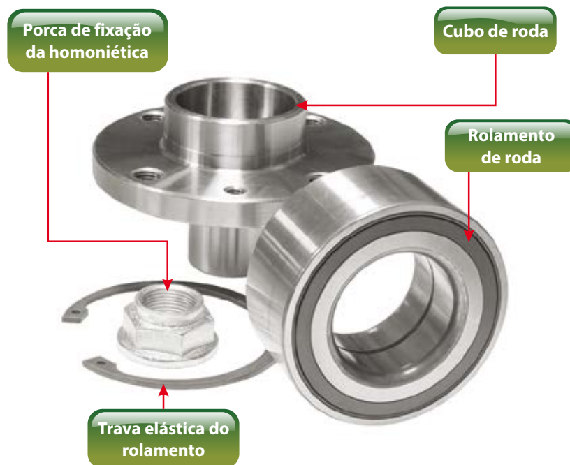
Figura 22 - Rolamento, cubo de roda, trava elástica e porca da homocinética Fonte: adaptado de Thinkstock (2015)
