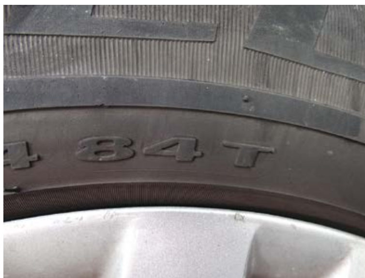
Figura 33 - Detalhe índice de carga e velocidade Fonte: Banco de imagens SENAI/SC – São José/Palhoça
