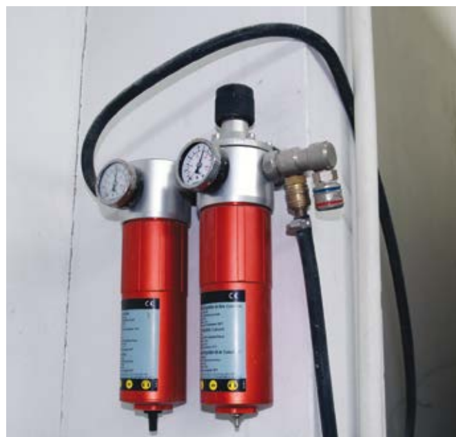
Figura 92 - Transformador pneumático Fonte: adaptado de Kobayashi (2013)
