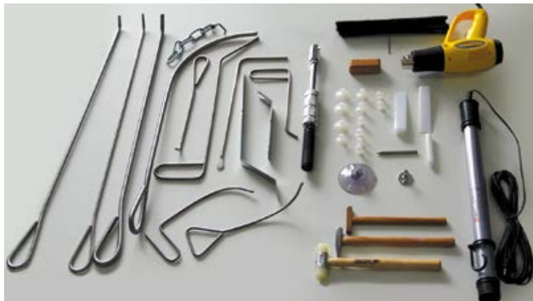
Figura 51 - Kit para aplicação da técnica Martelinho de ouro Fonte: Bao (2015)
