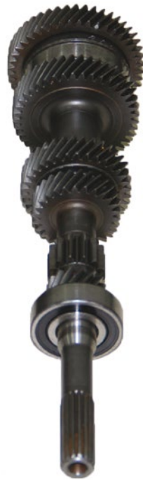
Figura 84 - Eixo primário de uma caixa de marchas mecânica Fonte: Banco de imagens SENAI/SC – São José/Palhoça (2016)
