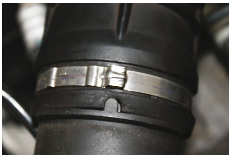
Figura 217 - Verifique o aperto das abraçadeiras para evitar vazamentos e futuros problemas Fonte: Banco de imagens SENAI/SC – São José/Palhoça (2016)
