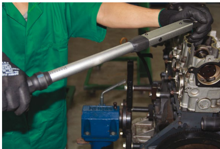
Figura 210 - Exemplo de aperto dos parafusos do cabeçote Fonte: Banco de imagens SENAI/SC – São José/Palhoça (2016)
