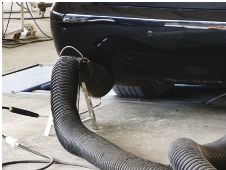
Figura 220 - Veículo fazendo teste de emissão de poluentes Fonte: Thinkstock (2016)
