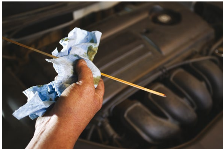
Figura 213 - Nível de óleo no motor, verificação de acordo com a literatura técnica Fonte: Thinkstock (2016)
