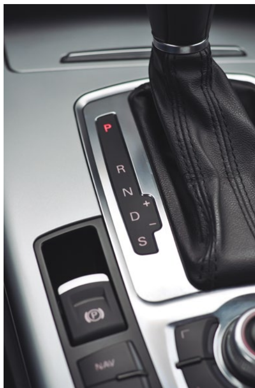
Figura 117 - Posições de uma alavanca de câmbio para uma transmissão automática Fonte: Thinkstock (2016)
