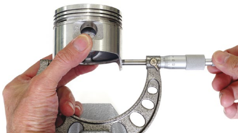
Figura 156 - Medição correta: travamento do micrômetro sendo feito pela catraca Fonte: Thinkstock (2016)
