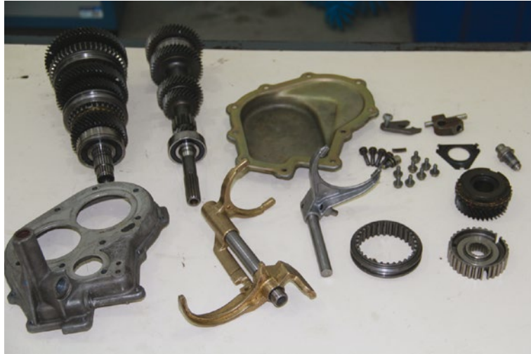
Figura 86 - Conjunto de garfos, varões e demais componentes responsáveis pelo engate das marchas. Fonte: Banco de imagens SENAI/SC – São José/Palhoça (2016)
