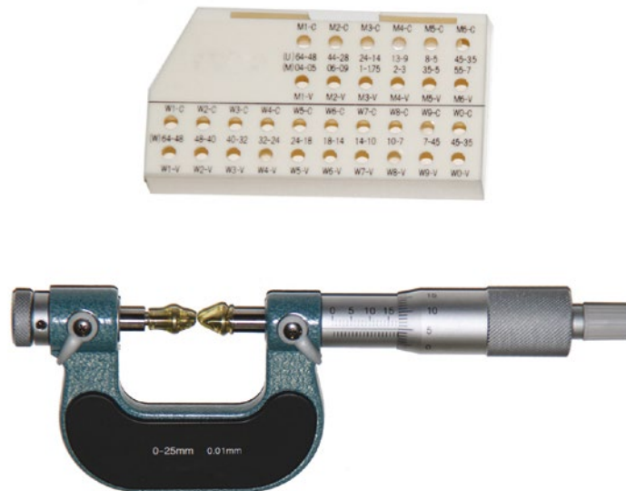
Figura 161 - Micrômetro para medição de diâmetro primitivo de rosca Fonte: Banco de imagens SENAI/SC – São José/Palhoça (2016)
