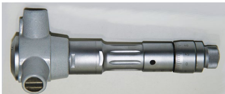
Figura 159 - Micrômetro para medição de dimensões internas Fonte: Banco de imagens SENAI/SC – São José/Palhoça (2016)
