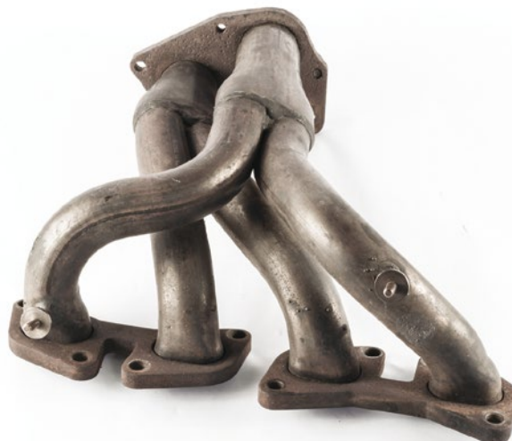
Figura 63 - Coletor de escapamento Fonte: Thinkstock (2016)
