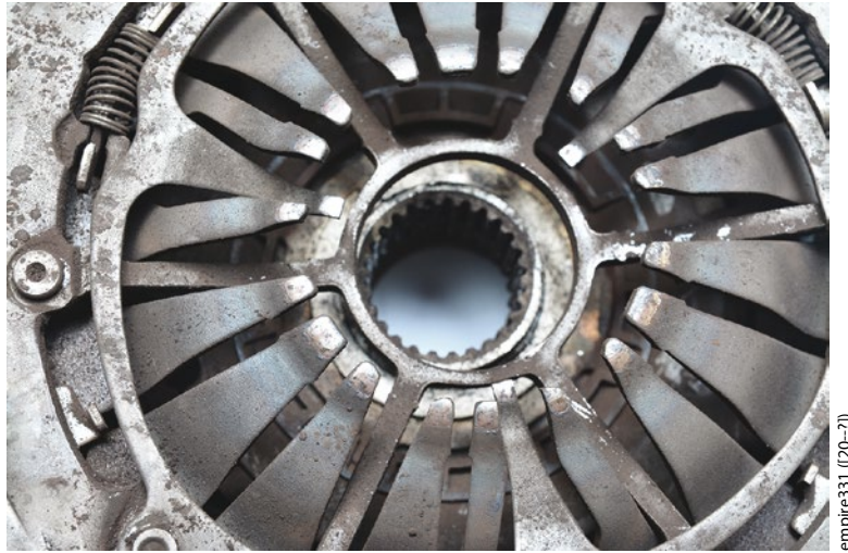
Figura 224 - Conjunto de embreagem deteriorado Fonte: Thinkstock (2016)
