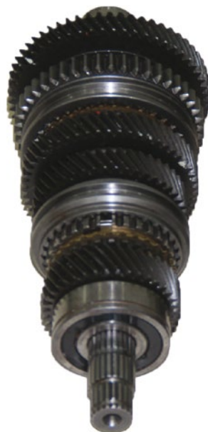
Figura 85 - Eixo secundário de uma caixa de marchas mecânica Fonte: Banco de imagens SENAI/SC – São José/Palhoça (2016)
