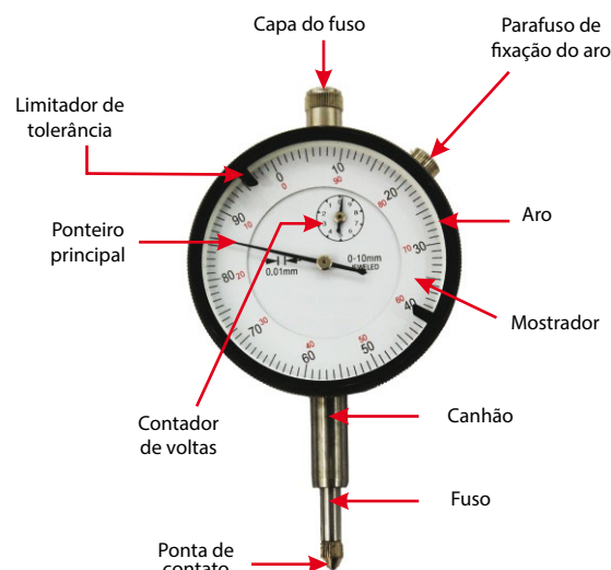
Figura 165 - Partes do relógio comparador Fonte: adaptado de Motta (2010)
