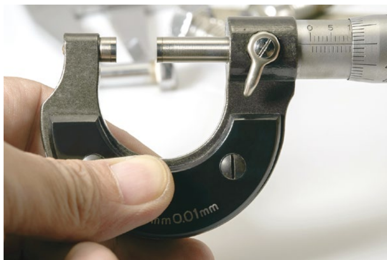
Figura 155 - Medição correta: operando o micrômetro pelo isolante térmico Fonte: Thinkstock (2016)
