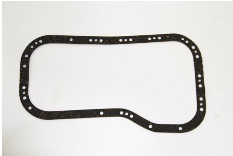
Figura 41 - Junta de vedação entre cárter e bloco
