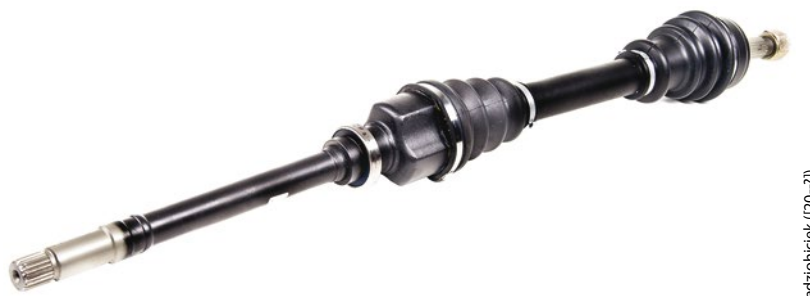
Figura 226 - Exemplo de juntas homocinéticas (externa) e tripóide (interna) montadas nos semieixos Fonte: Thinkstock (2016)
