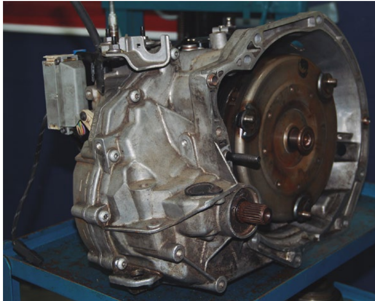
Figura 114 - Conversor de torque montado em uma caixa automática Fonte: Banco de imagens SENAI/SC – São José/Palhoça (2016)
