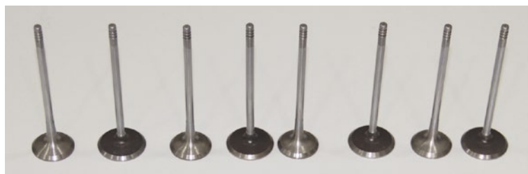
Figura 25 - Conjunto de válvulas de um motor.
