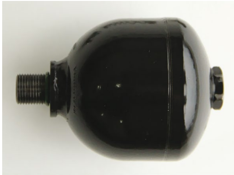
Figura 131 - Acumulador de pressão de um câmbio robotizado Fonte: Banco de imagens SENAI/SC – São José/Palhoça (2016)
