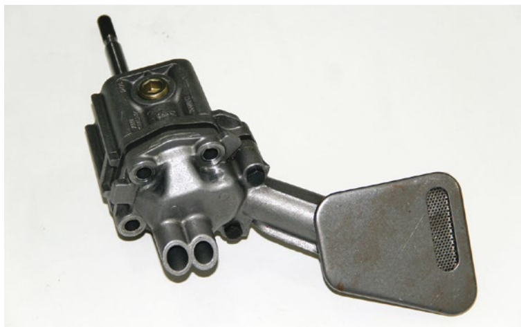
Figura 214 - Bomba de óleo com pescador; falta de limpeza compromete seu funcionamento Fonte: Banco de imagens SENAI/SC – São José/Palhoça (2016)
