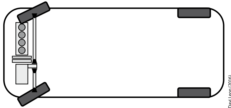
Figura 78 - Motor transversal Fonte: adaptado de Transmissão (2016)
