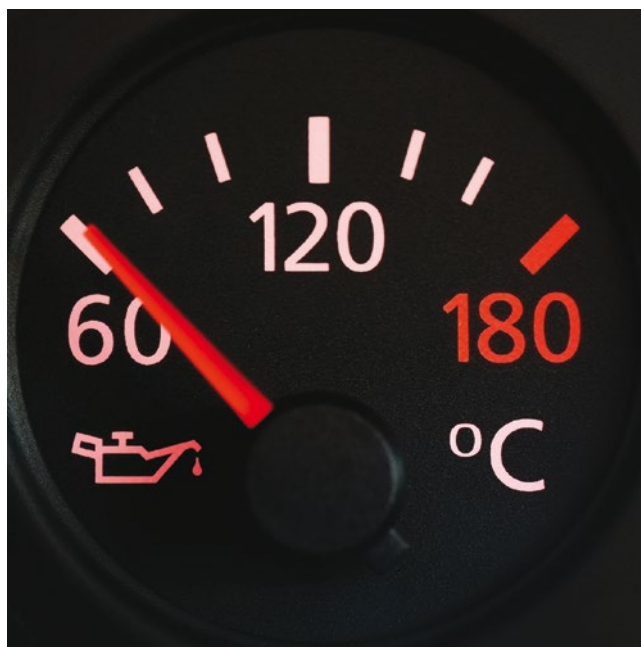
Figura 216 - Mostrador da temperatura do motor situado no painel Fonte: Thinkstock (2016)
