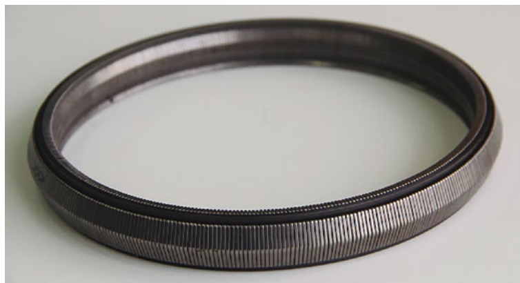
Figura 121 - Correia metálica de um câmbio CVT Fonte: Banco de imagens SENAI/SC – São José/Palhoça (2016)
