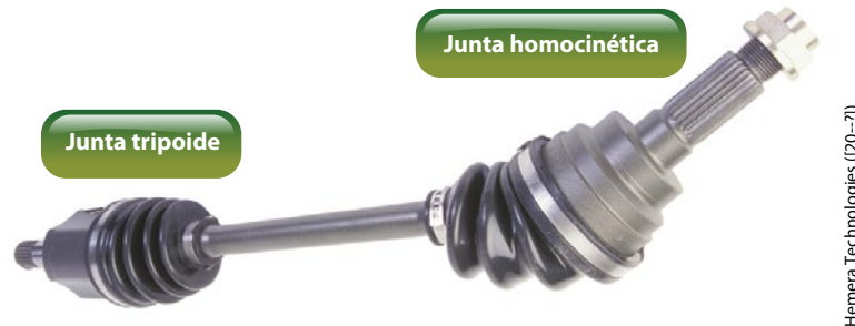
Figura 111 - Semi-eixo de um veículo que adota juntas homocinéticas no lado da roda e junta tripoide no lado do diferencial. Fonte: Thinkstock (2016)
