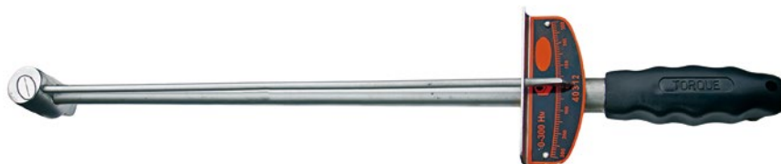
Figura 192 - Torquímetro de vareta Fonte: Thinkstock (2016)
