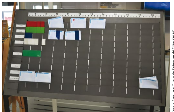
Figura 136 - Quadro para controle dos processos na oficina Fonte: do Autor (2016)
