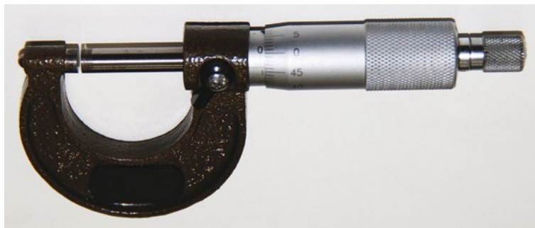
Figura 158 - Micrômetro para medição de dimensões externas Fonte: Banco de imagens SENAI/SC – São José/Palhoça (2016)
