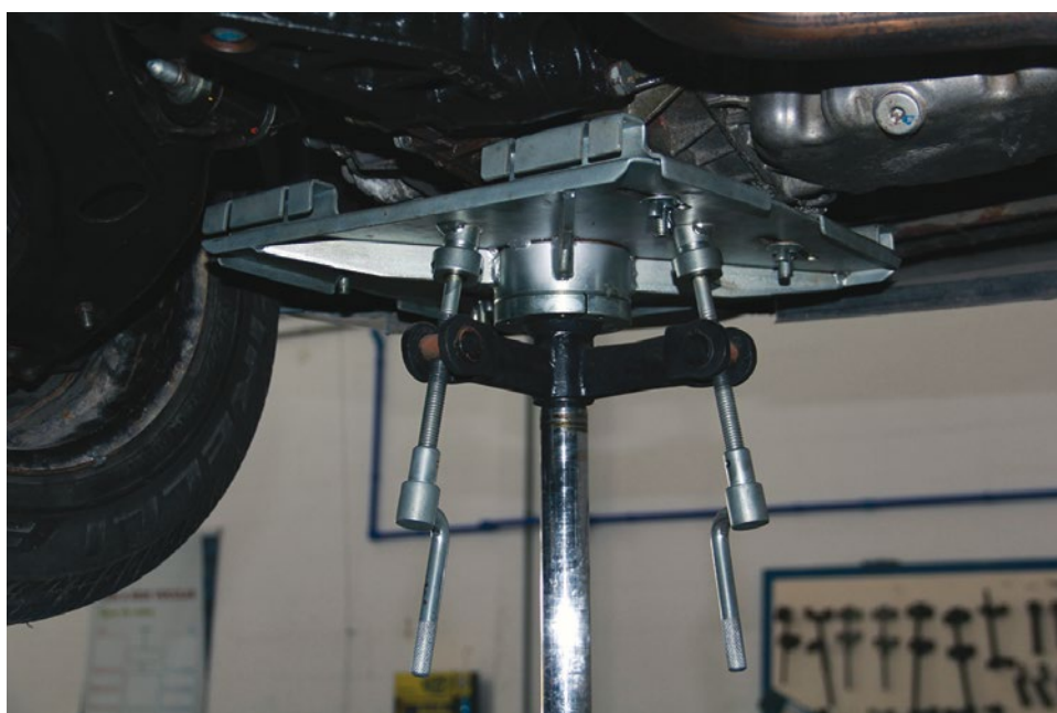
Figura 188 - Macaco hidráulico para transmissões Fonte: Volkswagen (1997)
