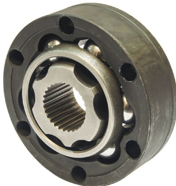
Figura 109 - Junta homocinética deslizante utilizada entre o diferencial e o semieixo Fonte: Thinkstock (2016)
