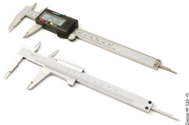
Figura 143 - Paquímetro digital e paquímetro analógico Fonte: Thinkstock (2016)
