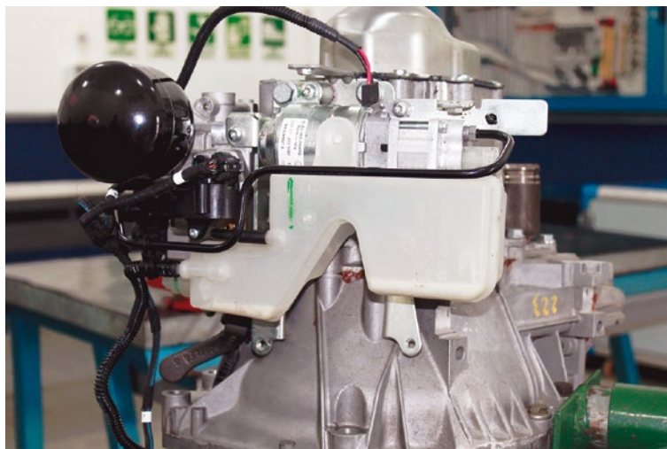
Figura 228 - Exemplo de câmbio robotizado Fonte: Thinkstock (2016)
