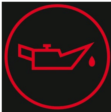
Figura 47 - Luz indicadora de anomalia na pressão de óleo Fonte: Thinkstock (2016)
