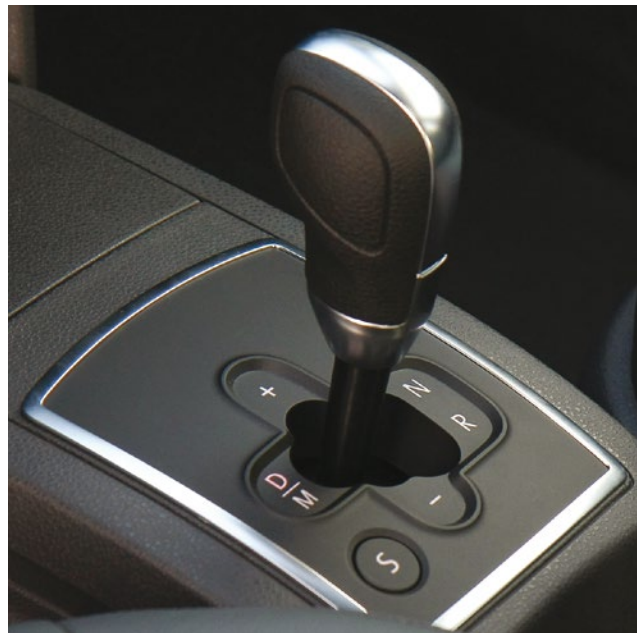
Figura 127 - Alavanca seletora de um câmbio automatizado Fonte: Banco de imagens SENAI/SC – São José/Palhoça (2016)
