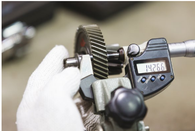
Figura 154 - Micrômetro digital fazendo o controle dimensional de uma engrenagem Fonte: Thinkstock (2016)
