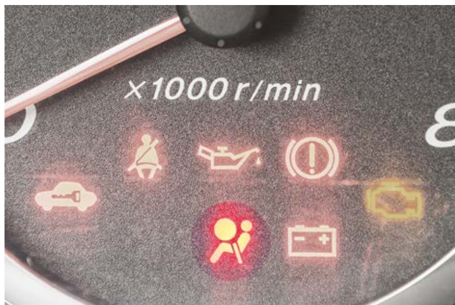
Figura 39 - Luz do sistema airbag no painel de instrumentos Fonte: adaptado de Thinkstock (2015)
