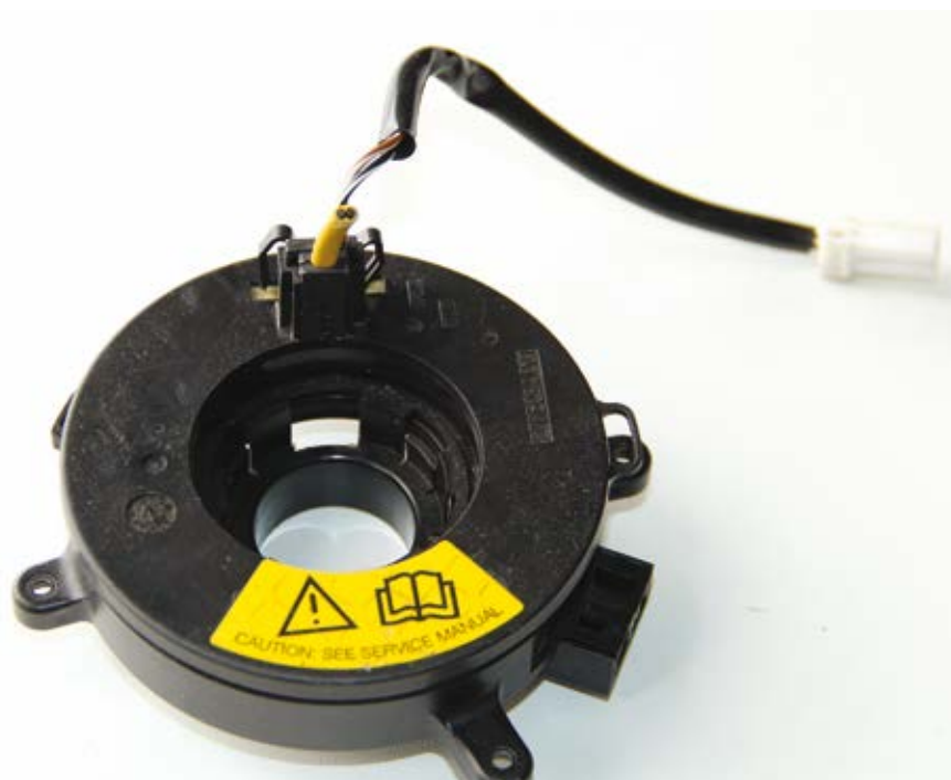
Figura 43 - Mola relógio/contato rotativo Fonte: Banco de imagens SENAI/SC – São José/Palhoça (2015)
