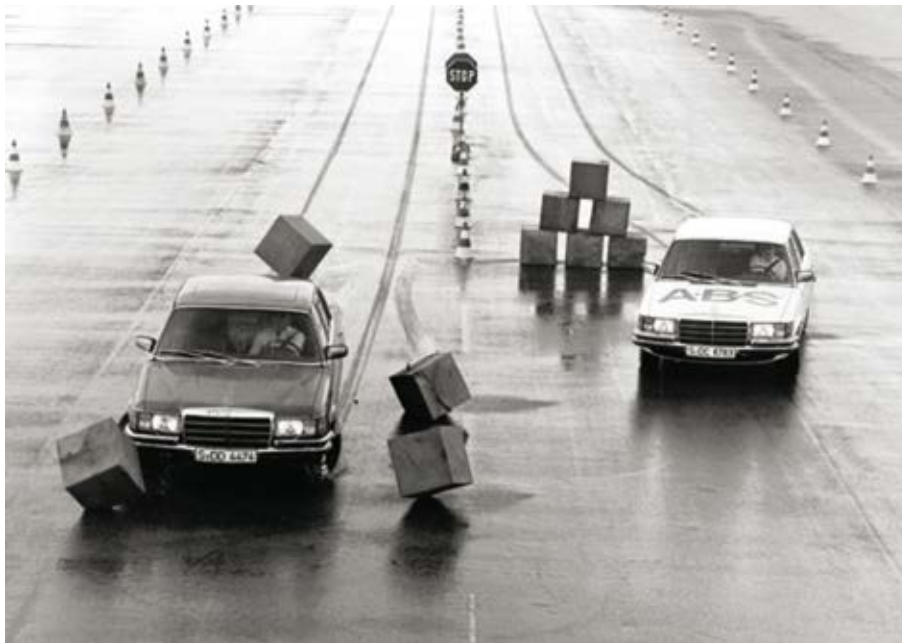
Figura 44 - Simulação de frenagem, veículo com e sem ABS Fonte: Autoblog (2012)
