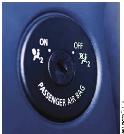
Figura 34 - Chave de desativação do airbag passageiro dianteiro Fonte: Thinkstock (2015)
