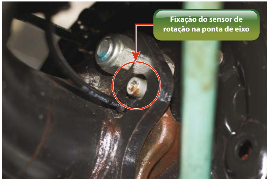
Figura 54 - Vista posterior do espelho do tambor de freio indicando a fixação do sensor Fonte: Banco de imagens SENAI/SC – São José/Palhoça (2015)
