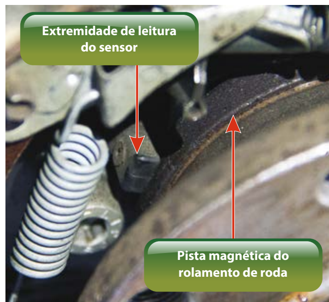
Figura 55 - Vista interna do tambor de freio indicando o sensor e a pista magnética do sensor Fonte: Banco de imagens SENAI/SC – São José/Palhoça (2015)
