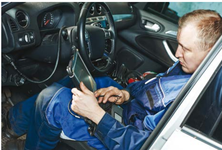
Figura 41 - Diagnóstico do airbag utilizando equipamento de diagnóstico scanner Fonte: Thinkstock (2015)
