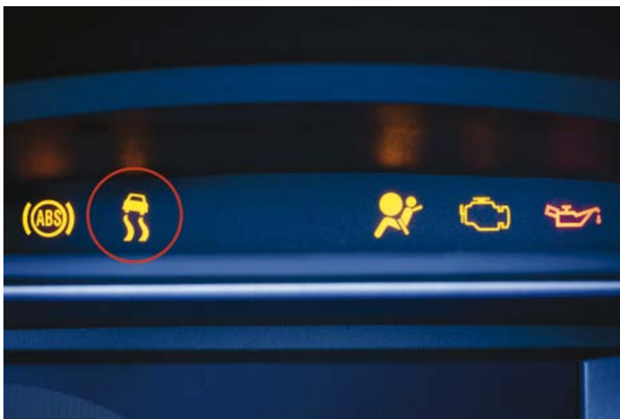
Figura 59 - Luz no painel do sistema ESP Fonte: adaptado de Thinkstock (20015)
