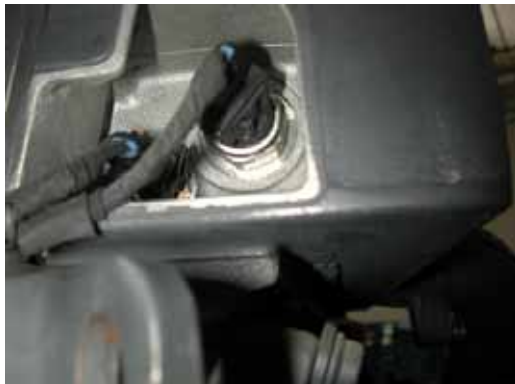
Vista do sensor de temperatura do ar, que está localizado na tampa do cabeçote do motor (série 900).
