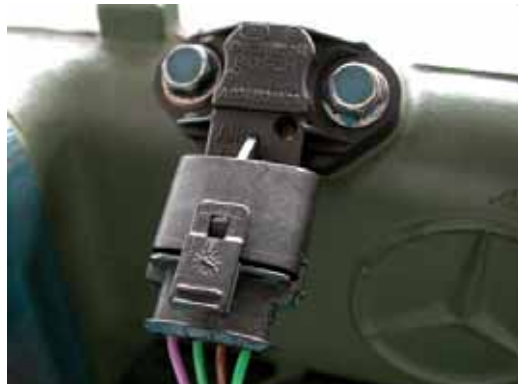
Vista do sensor de temperatura de pressão do ar, que está localizado na parte superior do motor (série 457).
